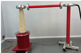
▲无线局放耐压试验装置
