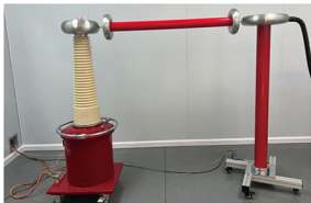
▲ 无局放耐压试验装置
